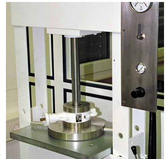
Prueba de estanqueidad con aire ultrapuro
